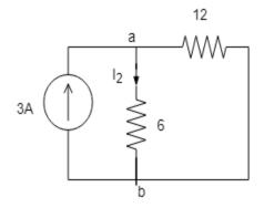
ملاحظة: عندما تكون اتجاهات التيارات متعاكسة في المقاومة المطلوب حساب التيار فيها فيجب طرح التيارات من بعضها وليس جمعها.
